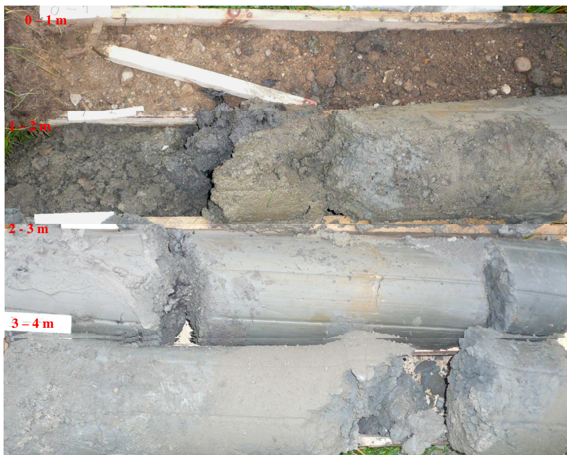
Obr.č.50. Vrtné jádro z vrtu DV-4 v jádrovnicích.
