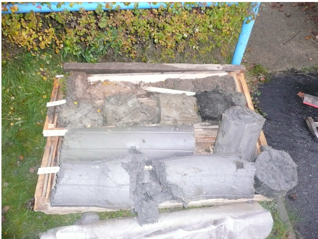
Obr.č.58. Jádno vytěžené z vrtu DV-5 – celkový pohled.
