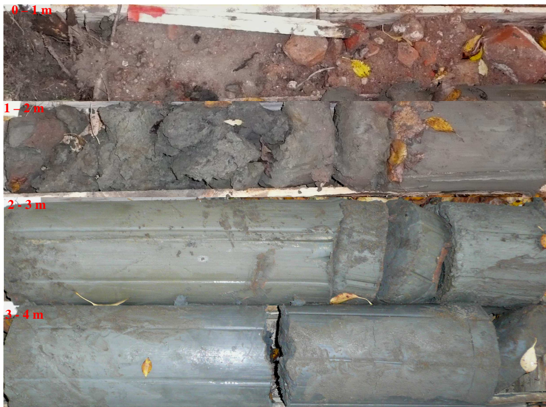
Obr.č.26. Vrtné jádro z vrtu DV-2 seřazené podle jednotlivých návrtů (1 – 4 m).
