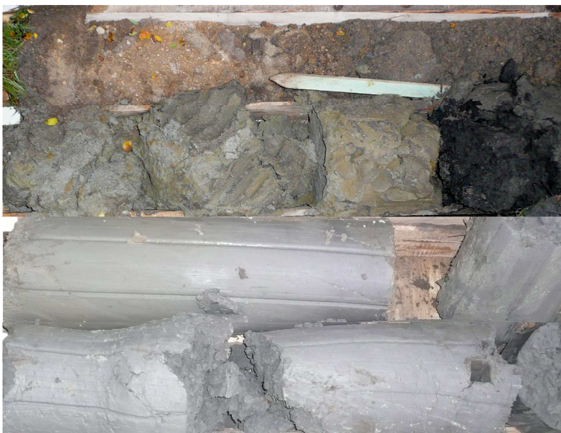
Obr.č.59. Vrtné jádro z vrtu DV-5 v jádrovnicích.
