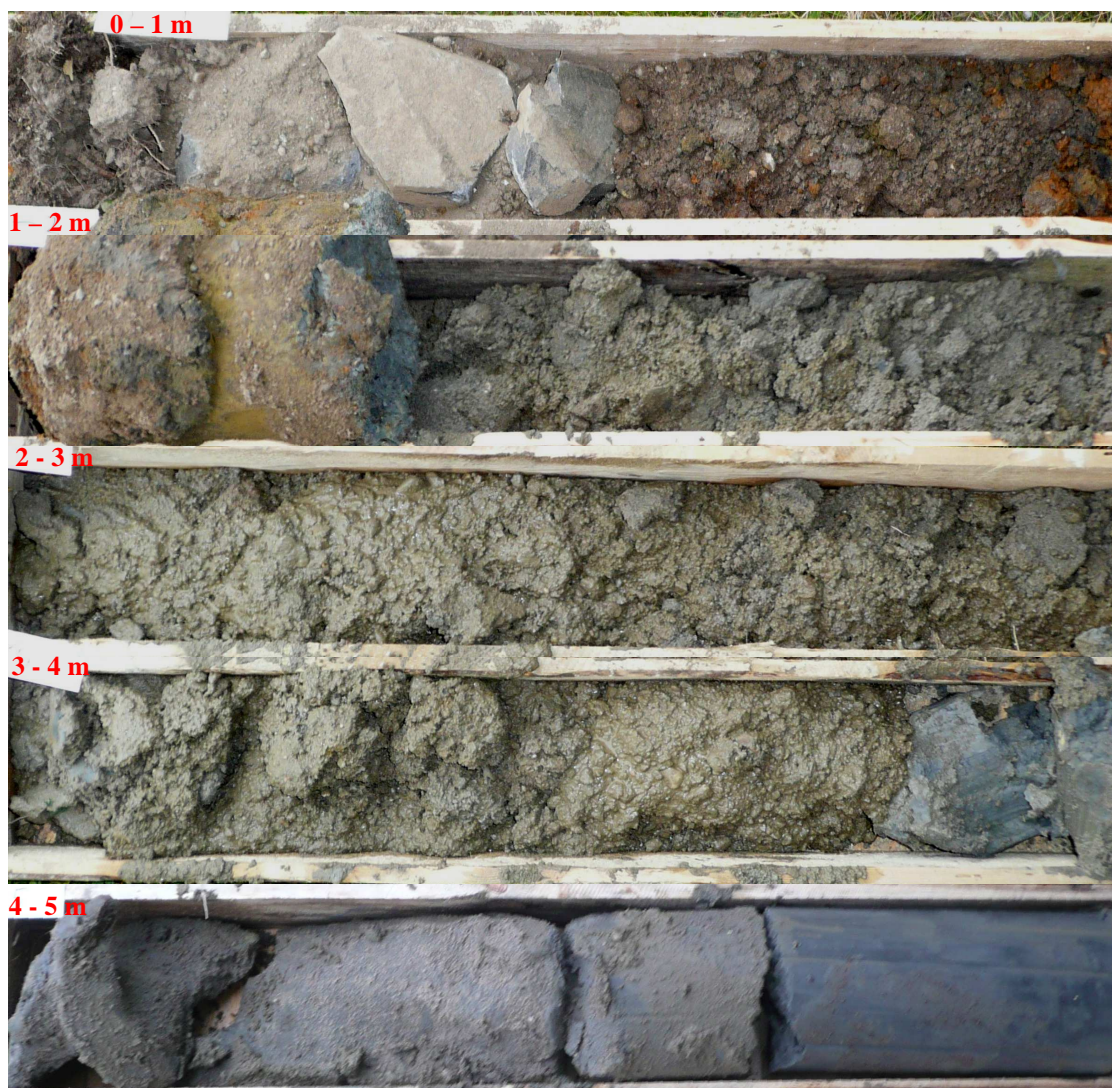
Obr.č.20. Vrtné jádro z vrtu DV-1 seřazené podle jednotlivých návrtů (1 – 5 m).
